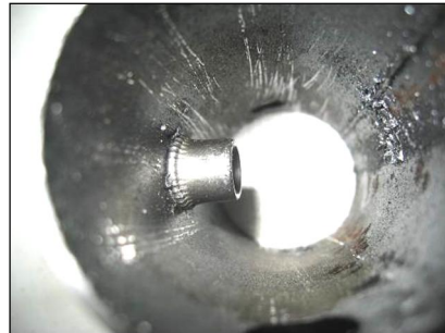
Bild 35 Darstellung der Einietmutter im eingebautem Zustand
